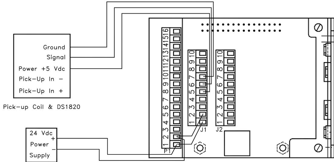
Figure 18. UPCC DS1820 Temperature Sensor Wiring
